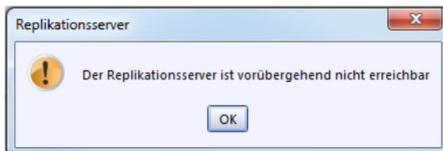
Tritt diese bei einem Replikationsversuch auf, ist zunächst zu prüfen, ob der betreffende Server direkt mit dem zentralen Replikationsserver oder aber mit einem kaskadierten Replikationsserver verbunden wird. Hierfür kann die URL des Replikationsservers aus den Konfigurationsdateien „config.ini“ bzw. „config.local.ini“ verwendet werden (siehe Kapitel 5.3.1).
